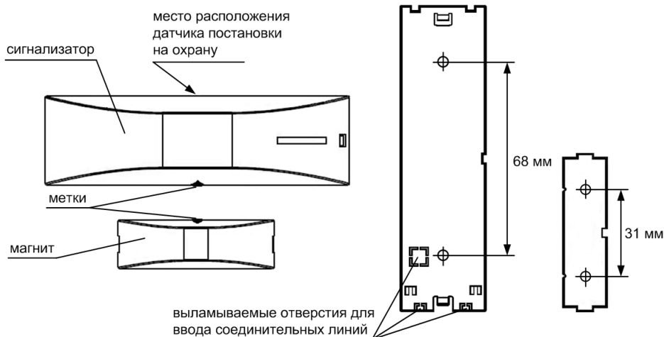
Рис.9 Схема установки, присоединительные размеры
