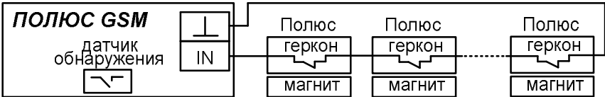
Рис. 6б Схема подключения внешних датчиков. Значение «1» в ячейке №37
